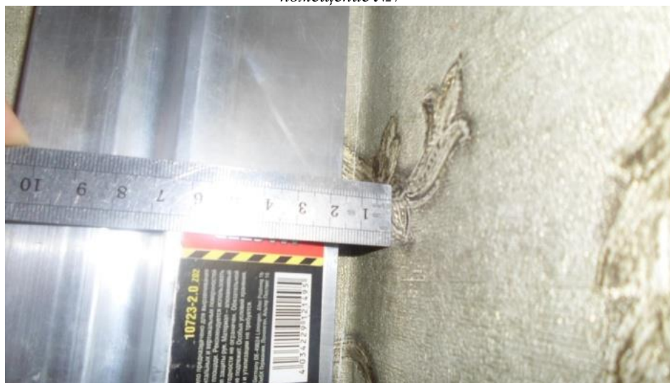
расстояние между контрольной двухметровой рейкой и пошпательными поверхностями превышают предельно допустимые значения
