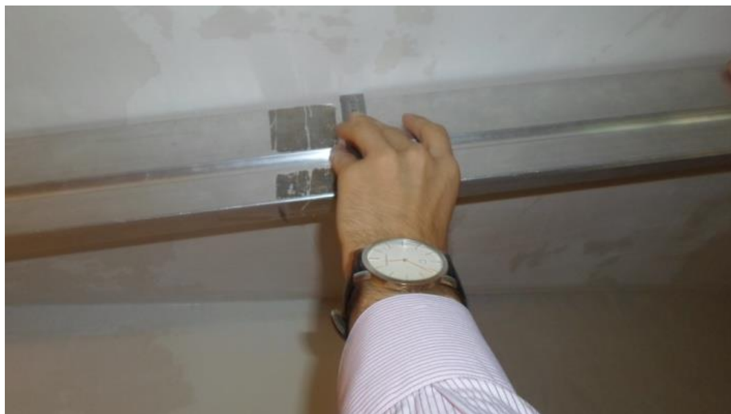
расстояние между контрольной двухметровой рейкой и пошпатлеванными поверхностями превышают предельно допустимые значения
