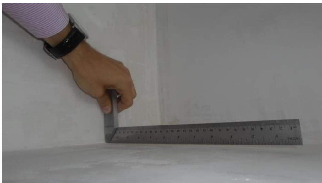
отклонение поверхности стен от уровня в углах комнаты
